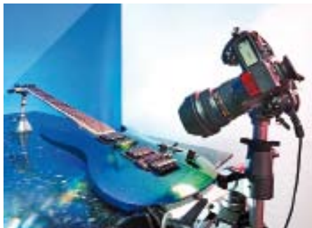
Studioaufbau: Gitarren-Bild in 37 Einzelaufnahmen, Blende 5,6, Weitwinkelobjektiv
